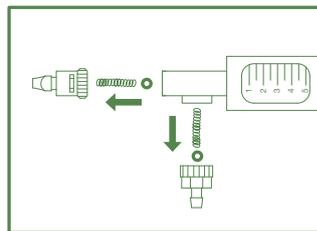
Si inefficace, démonter la soupape et
