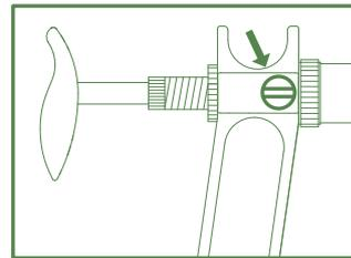
Ajuster le corps et la poignée en dévissant la vis positionnée sur le côté.
