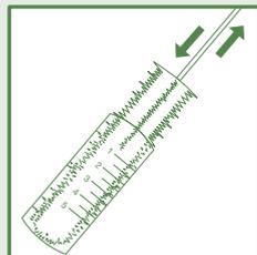
Nettoyer les dépôts dans le cylindre
