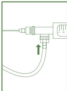
Raccorder tuyau et seringue.
